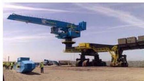
Speciale kraan voor plaatsen van betonblokken Henrik-Willem Hofs / NOS
