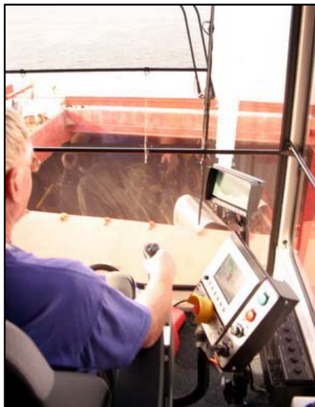
Het gebruiksvriendelijke HMI (Human-Machine Interface) helpt kraanman Stan om veilig raapzaad te halen uit het ruim van het panamax schip.
