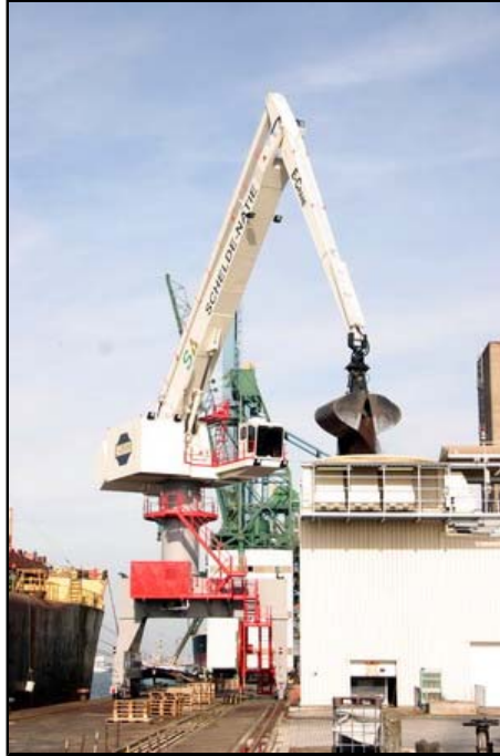
E-Crane® aan het werk met een 10m3/13.07yd3 hydraulische gripper
